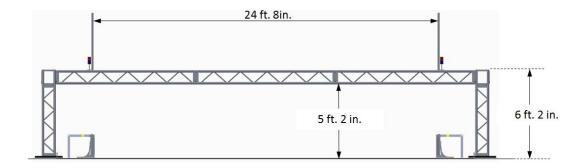
Figure 2-10: The TRUSS
